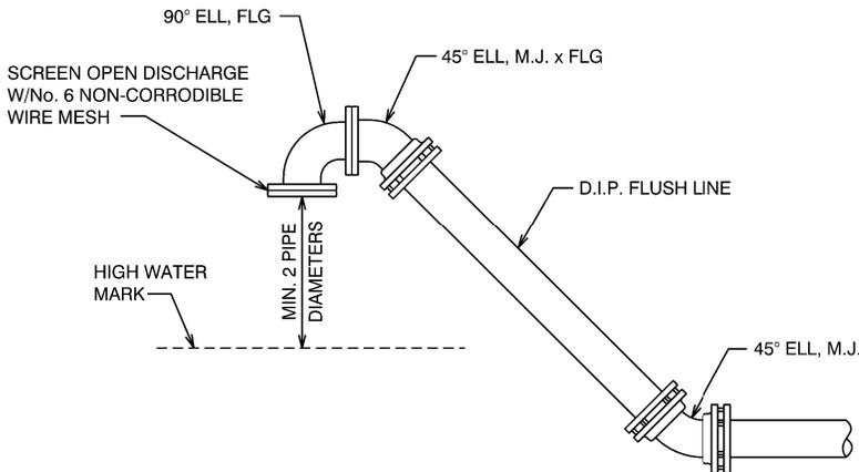
**FLUSH LINE DISCHARGE DETAIL**
